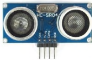
Рисунок 1- Ультразвуковой датчик расстояния
