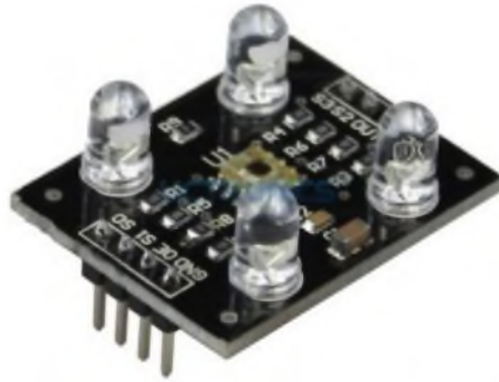
Рисунок 4 - Датчик определения цвета объекта
